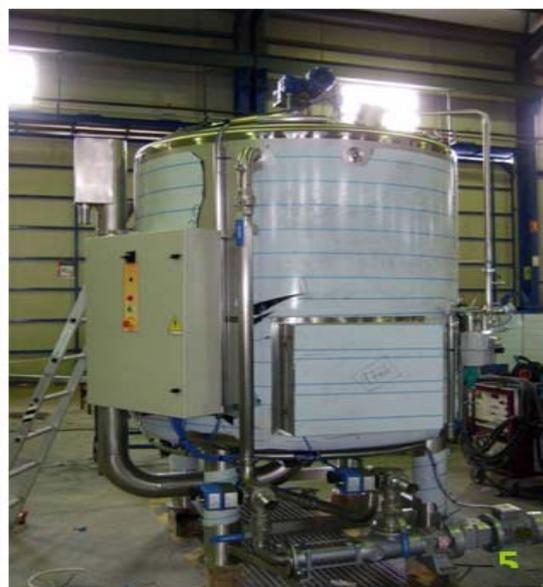
Auxiliar digester anaerobio y Digester anaerobio piloto.
