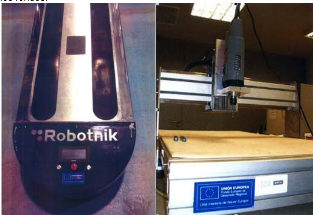
Prototipo del dispositivo de mecanizado de espumas automatizado y transportable
